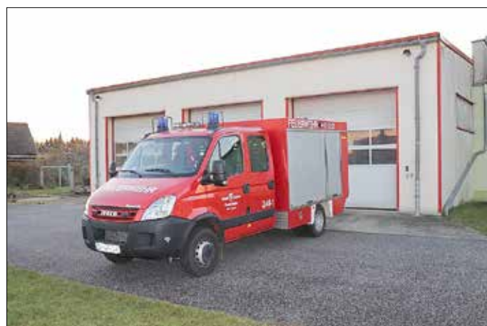
Einsatzfahrzeug TSF-W - Tragkraftspritzenfahrzeug mit Wasser.
