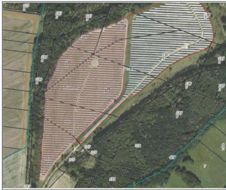
Abbildung: Planentwurf Erweiterungsfläche (rot hervorgehoben) mit 5 MWp
