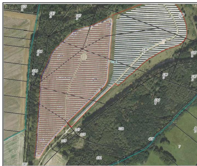
Abbildung: Planentwurf Erweiterungsfläche (rot hervorgehoben) mit 5 MWp
